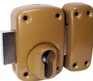
Ce verrou de sûreté pour cylindre européen de marque Thirard (cylindre non fourni) permet une **fermeture solide de vos portes**. Son boîtier est en époxy verni, son coffre et sa gâche en acier embouti, et son pêne est nickelé.
