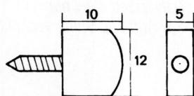
Taquet laiton avec vis double filet acier.
