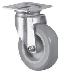
Cette roulette pivotante de marque Tente permet un déplacement facile de vos meubles. Elle a un pivot sur double **roulements à billes** et est muni d'un système de blocage total de la roue et du pivot. Elle est réalisée en polypropylène avec un bandage en polyuréthane gris à moyeu lisse.
