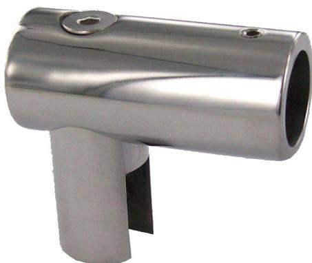
Pince à embout orientable pour raidisseur de cabine de douche, pour tube rond d.19mm ou tube carré 19x19mm.
