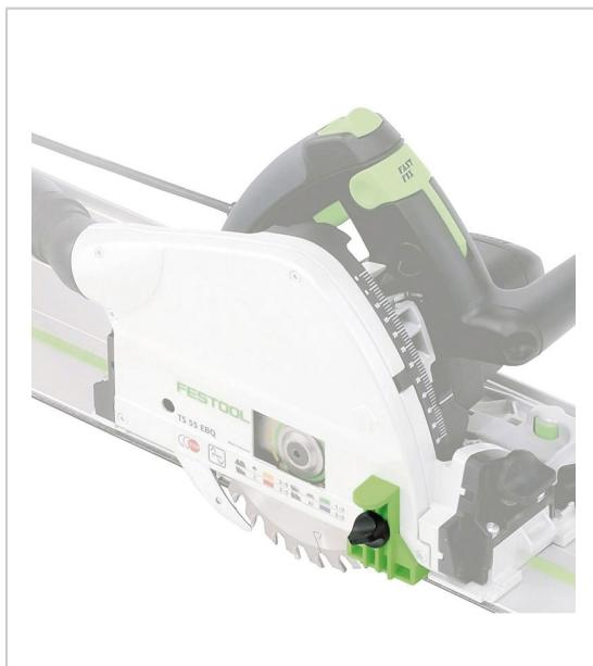
Le pare-éclats se monte à la place de la fenêtre d'inspection et réduit l'arrachement à droite de la lame de scie pendant la coupe. Une fois l'outil mis en marche, l'utilisateur entaille le pare-éclats monté pour l'adapter parfaitement à la lame de scie. Le pare-éclats peut être décalé en hauteur et convient donc à la coupe avec et sans rail de guidage.
