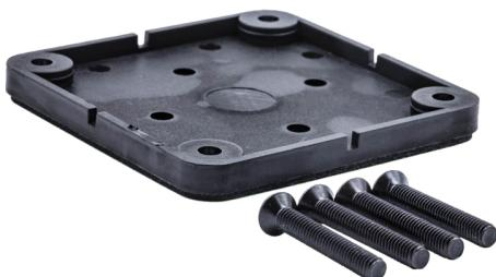
Kit de fixation pour serrure électronique de meuble réf. 076 50000 00002, composé d'une plaque de fixation avec adhésif double-face et vis fournies.
