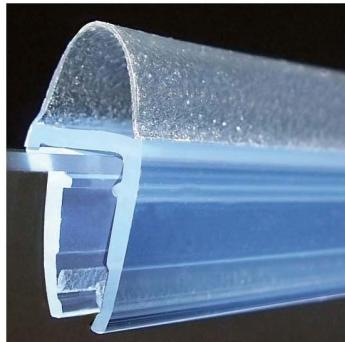
Joint d'étanchéité en PVC bi-dureté translucide pour étancher les cabines de douche en verre permet d'empêcher les fuites de liquides au niveau d'un raccord de votre WC ou salle de bain.
