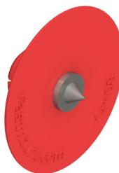
L'insert de centrage se fixe sur tout les clips femelles de la même gamme. Une fois fixé, placer le panneaux dans la position voulue par rapport à la structure. Les inserts laisseront une marque aux endroits correspondants aux perçages sur le panneau. Il permet de repérer exactement l'emplacement des perçages et garantit l'alignement parfait des clips.
