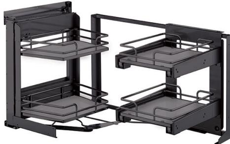
L'ouverture de la porte entraîne l'extraction du cadre pivotant faisant ainsi coulisser face à l'ouverture les corbeilles situées dans l'angle mort du meuble permettant ensuite de les extraire vers l'extérieur.
