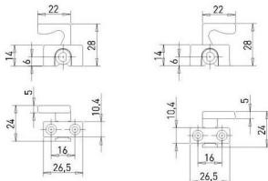
Ce crochet est réalisé en zamack.
