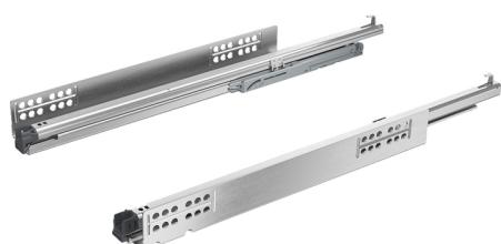
Coulisse Quadro You Push to Open pour tiroir AvanTech You ou tiroir en bois avec clips. Le mécanisme d'ouverture Push to Open est intégré. Installation ultérieure possible de la synchronisation. Capacité de charge suivant la norme EN 15338, niveau 3.
