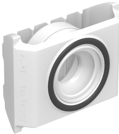
Le clip femelle SL-FBFR permet une installation rapide de panneaux verticaux lourds **sur des fourrures en acier galvanisé standard de 45x18mm**. Il est résistant au feu, donc adapté pour panneaux coupe-feu.
