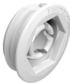
Le clip femelle LOW PROFILE autotaraudeur LP-F8 pour montage en insert dans des panneaux de contreplaqué ou MDF. Particulièrement indiqué lorsque la structure présente une profondeur restreinte et panneaux courbes. De préférence, utiliser ces clips pour les applications de panneaux verticaux.
