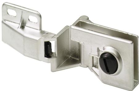
Charnière pour porte en verre en applique Dimension de porte maxi 1000 x 600 mm Angle d'ouverture 170° épaisseur de verre maxi 6,3 mm Jeu de porte en haut et en bas 3,3 mm, jeu latéral 11,5 mm. La charnière est montée sur la porte en verre à l'aide d'une vis de serrage, supprimant ainsi tout perçage du verre. Zamak
