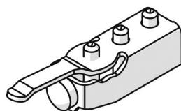
Butée de rail mobile avec ressort de blocage réglable.
