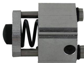
Si le chant de la porte à galandage doit affleurer le bord du châssis en position rentrée, il est recommandé de remplacer la butée fournie avec le kit par cette butée à ressort. Elle permettra l'extraction du vantail, pour une meilleure saisie, après une pression sur son chant.
