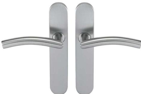
Double béquille Ø 19 mm, sur plaques longues solidaires, munie d'un ressort de rappel, avec sous-plaques en métal.
